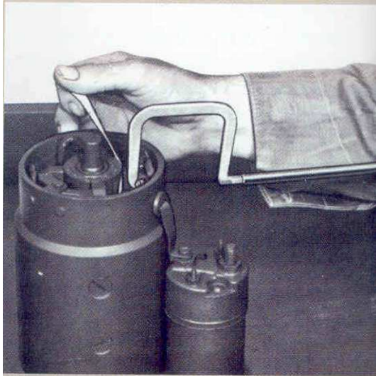
Prüfen der Bürstenfederkraft.
